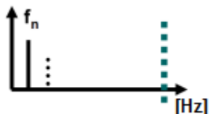
10.54 ábra: Egyenetlen gépágy spektrumképe
