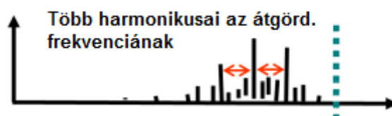
10.29 ábra: Előrehaladott csapágykárosodás spektrumképe a gyorsulás görbén
