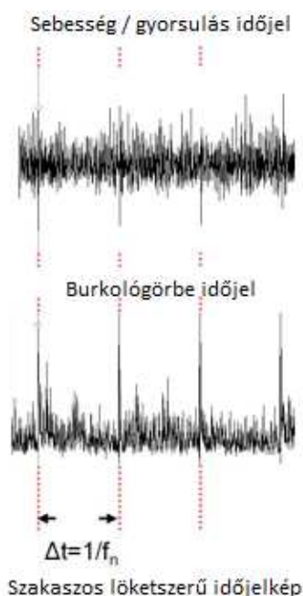
10.86 ábra: Törött fog időjelképe
