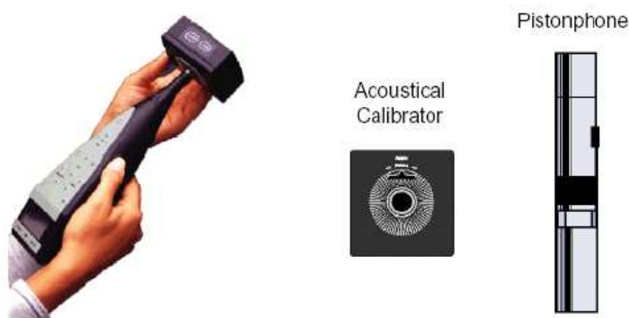
7.5 ábra: Zajszintmérő mikrofon kalibrálása pisztolfonnal
