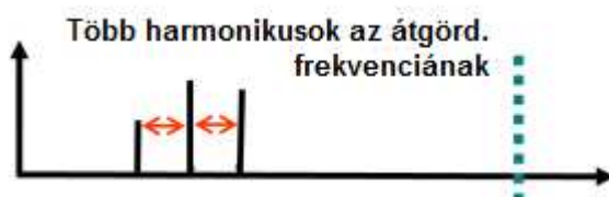
10.32 ábra: Végleges csapágykifutás
