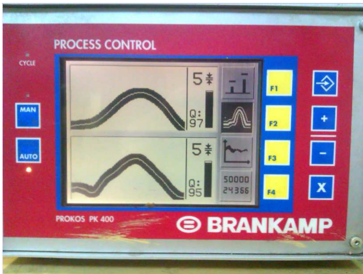
8.1 ábra: N101 görgőprésgép préserő felügyeleti rendszere
