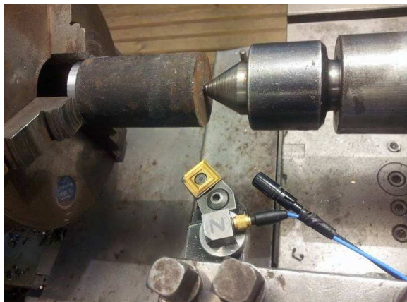
6.25 ábra: Szeszámkopás céljából zaj-és rezgésmérés esztergálás során
