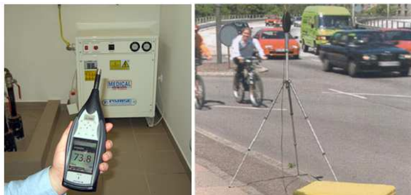
7.6 ábra: Gépjaj és környezeti zajterhelés mérése
