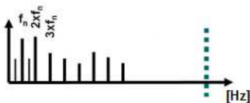
10.57 ábra: Lazán illesztett alkatrészek spektrumképe
