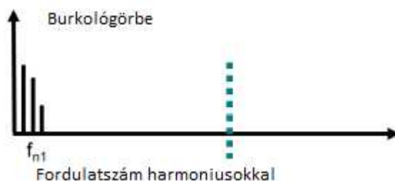
10.77 ábra: Szögeltérési hiba burkológörbe spektrumképe
